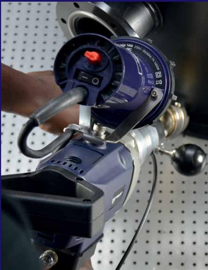
Мощный, долговечный, недорогой аппарат для ручной экструзионной сварки производительностью до 3,4 кг/час. Предназначен для производства изделий из пластика, хорошо подходит для вертикальных работ. Может использоваться в гражданском и подземном строительстве.
