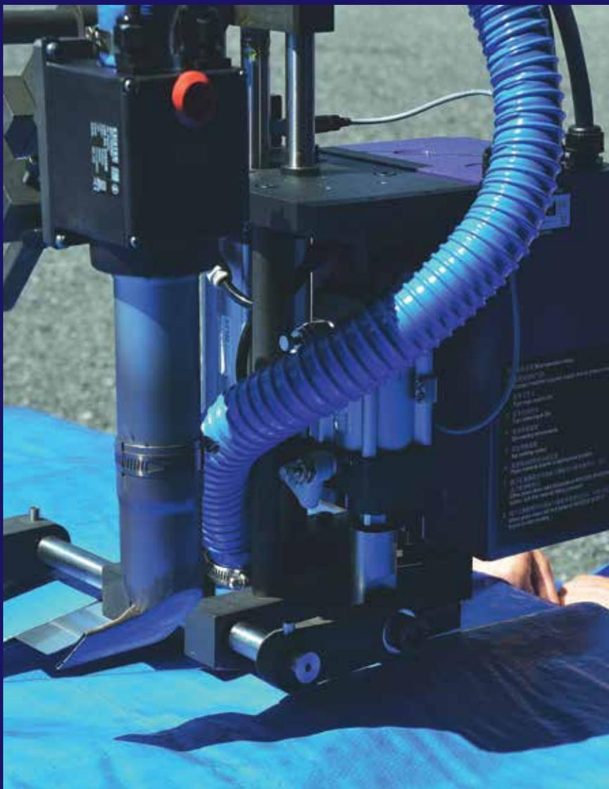
Высокопроизводительный компактный стационарный аппарат для сварки горячим воздухом. Применяется для сварки технических ПВХ-тканей при производстве разнообразных рекламных конструкций, тентовых конструкций, шатров, палаток, временных укрытий, навесов, маркиз и много другого.
