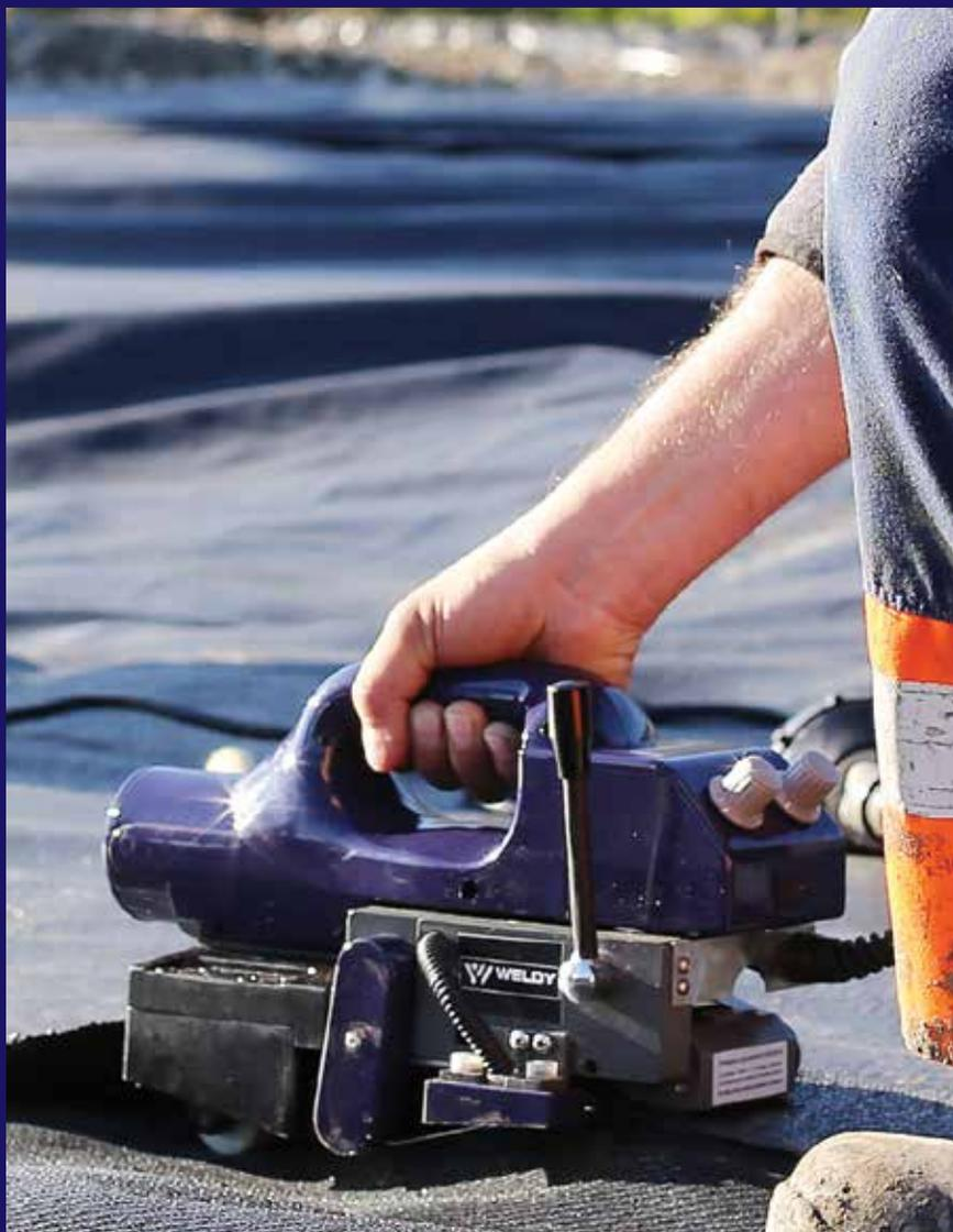
Компактный, лёгкий и производительный сварочный автомат горячего клина для сварки материалов толщиной от 0,2 до 1,5 мм. Может использоваться при сварке внахлест гидроизолирующих покрытий и геомембран, бассейнов, искусственных водоемов, водоемов для разведения рыбы, гидроизоляции для кровли, фундаментов, резервуаров, при озеленении и т.д.
