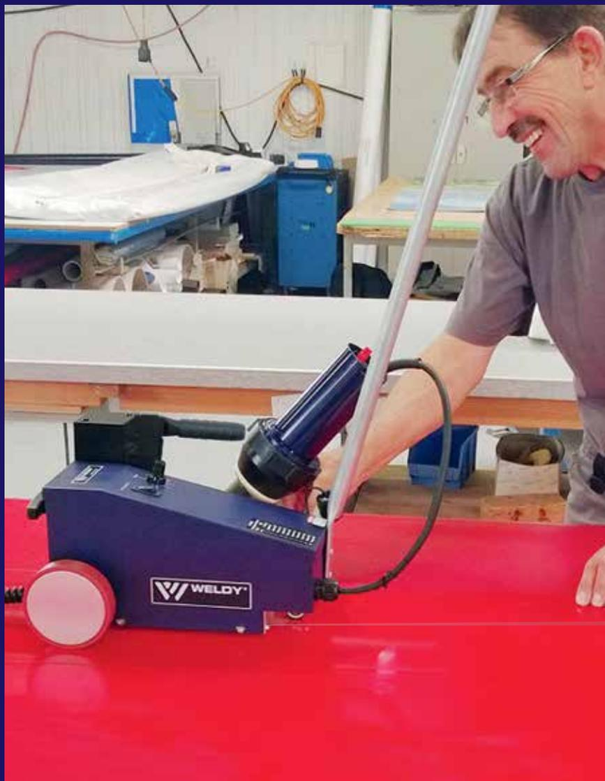
Автоматический аппарат для сварки внахлест горячим воздухом технических ПВХ-тканей, баннерных и тентовых тканей, гомогенных и многослойных гидроизолирующих покрытий. Используется при производстве шатров, павильонов, автомобильных тентов, промышленных завес, навесов, рекламных и баннерных конструкций, укрывных пленок для строительства и сельского хозяйства, бассейнов, гомогенных и многослойных гидроизолирующих покрытий из ПВХ, ПЭ, ХСПЭ, ПВДФ и ЭСБ.
