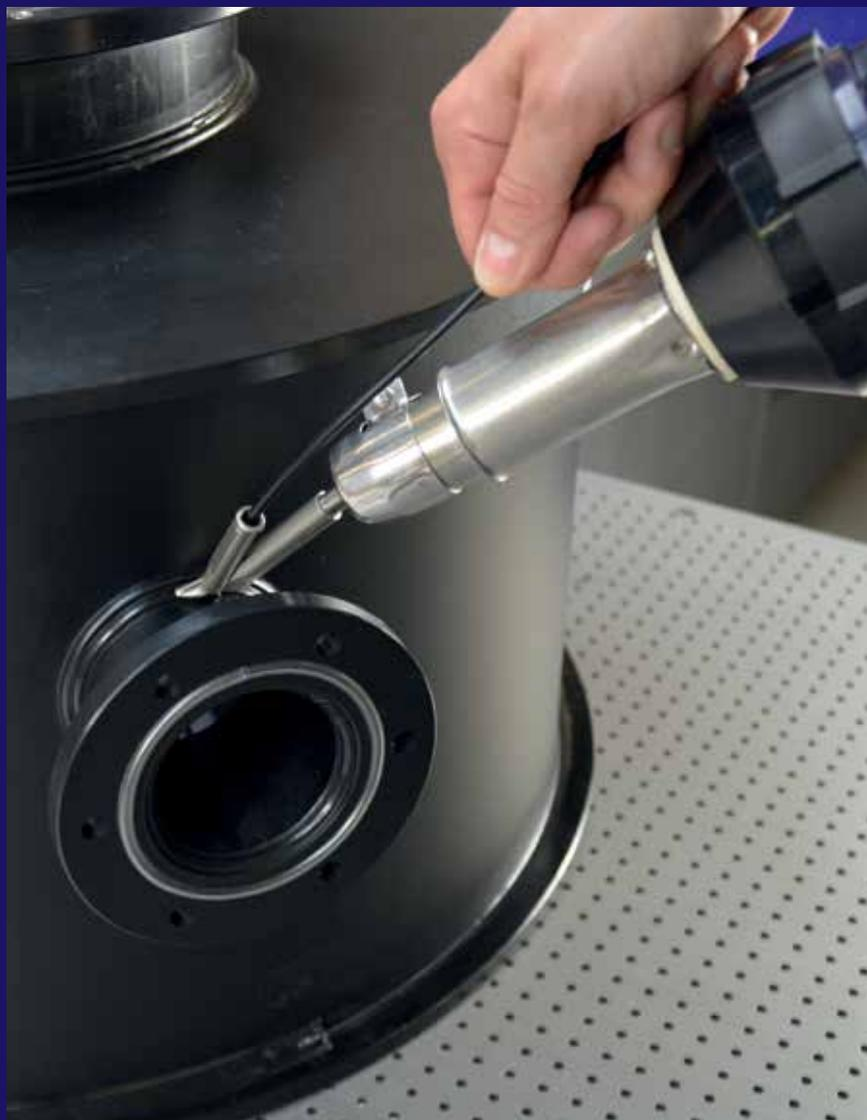
Компактный и надежный аппарат WELDY Energy 1600 для ручной сварки горячим воздухом. Набор с Energy 1600 подходит для сварки пластиковых изделий из полимерных листов, сварки полимерных труб, пластмассовых деталей, усадки термоусадочных трубок, муфт, пленок, ремонта автотранспортных средств, а также сварки и укладки напольных покрытий (сварка прутом, сварка шнуром, как вспомогательный аппарат при укладке покрытий).
